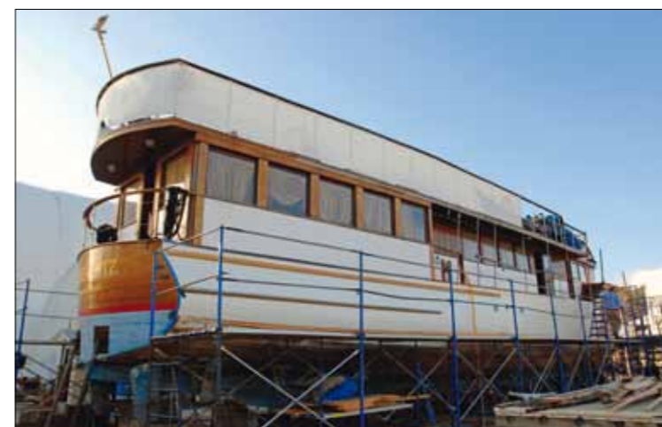
Cette photo montre bien le rajout de la superstructure arrière, qui prolonge le salon jusqu'à la poupe. Jim aurait aimé revenir à la silhouette d'origine mais ce n'est pas inscrit dans son contrat de restauration.
